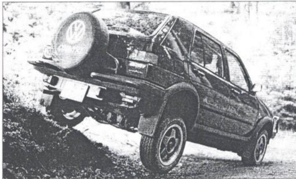
Böschungswinkel von 29° vorne und 22° hinten sowie die Bodenfreiheit von 18 cm gestatten es, auch ein steileres Bord zu bewältigen.
