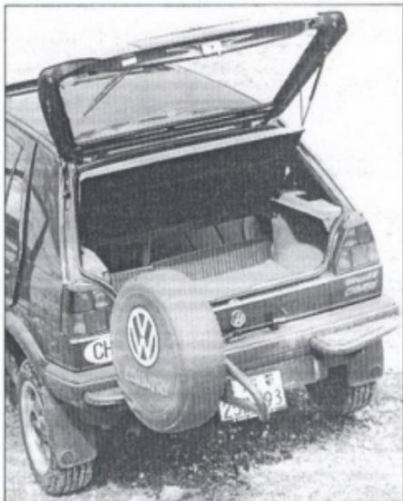
Der Träger des in einer Hülle steckenden Reserverades lässt sich nach links aufschwenken, worauf auch die normale Golf-Heckklappe geöffnet werden kann. Die Rücklehne lässt sich zur Vergrösserung des Kofferraums in zwei asymmetrischen Teilen abklappen. Beidseitig des Reserverades finden sich am Stosschutz integrierte Trittstufen.
